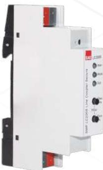
Der LCS200S ist ein kompakter KNX-Leitungsverbinder. Er verbindet zwei KNX-Datenbus-Segmente miteinander. Das Gerät verfügt über eine erweiterte Filtertabelle für die Hauptgruppe 0..31 und sorgt für eine galvanische Trennung zwischen den Leitungen. Der Konnektor unterstützt KNX-Datensicherheit und KNX- Longframes. Er ist kompatibel mit der ETS®-Software ETS 5 oder höher
