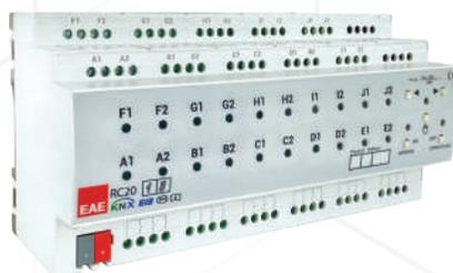
Ein-/Ausschalten, HLK, Jalousie-/ Vorhangsteuerung. 20x16A Relaisausgang Schalten von ohmschen und induktiven Lasten 18 unabhängige Eingangskanäle 7 Funktionen pro Kanal (Treppe, externe/ interne Logik, Priorität, Schwellenwert, Kehraktionen und Übergangszeit)
