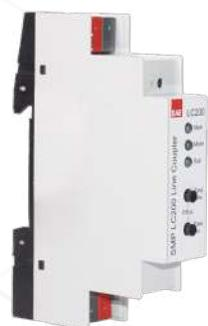
Integrierte Filtertabellen für gruppenorientierte Kommunikation. Unterstützt lange Nachrichten mit einer APDU-Länge von bis zu 240 Byte. Galvanische Trennung zwischen KNX-Leitungen. Flexibel als Leitungsverbinder, Feldverbinder oder Backbone-Verbinder einsetzbar. Keine zusätzliche Stromversorgung erforderlich
